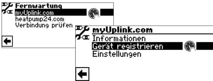
Falls die Seriennummer der Wärmepumpe zu diesem Zeitpunkt noch nicht im Heizungs- und Wärmepumpenregler eingegeben ist, erscheint zunächst eine Aufforderung, die Seriennummer einzugeben. Die Eingabe der Seriennummer ist an dieser Stelle ab dem Zugang „Benutzer“ möglich.
