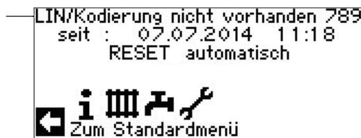
Beispiel eines im Bildschirm angezeigten Verbindungsfehler
